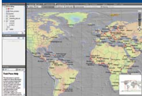
Die Weltkarte mit Hauptstädten wurde anhand von DEM-Rasterdaten sowie Vektordaten aus SDF- und Oracle-Quellen auf der Grundlage flexibler Layoutvorlagen generiert.
